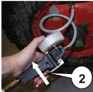
Abzug (2) ca. halb in Richtung Griff drücken, der Reifen-Luftdruck wird reduziert. Für die Kontrolle des Luftdrucks Abzug (2) zwischenzeitlich loslassen.
